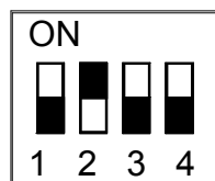
DIP-Schalter für die I/O-Adresseinstellung, hier 390 H
